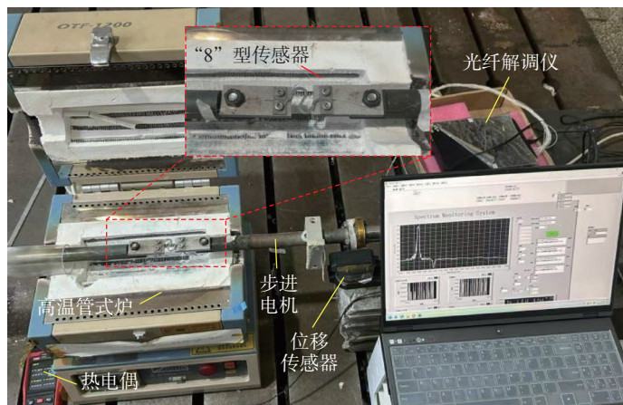
图6 “8”型传感器温度-应变试验平台
